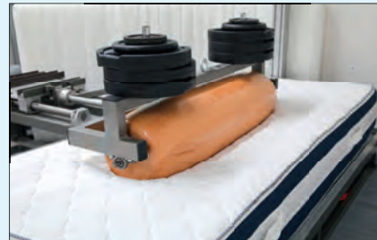
Dauerbelastung: Eine mit Gewichten beschwerte Holzwalze simuliert jahrelange Belastung.
