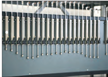
Liege-Profil: Eine Reihe von Schiebern unter der Matratze bildet ein „Negativ“ des liegenden Körpers.
